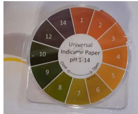
pH-Wert im Boden messen (Handelsbezeichnung: Pehameter) und pH-Indikator Papier
