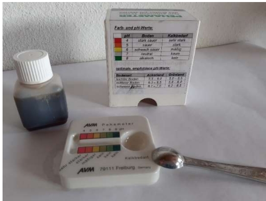
pH-Wert im Boden messen (Handelsbezeichnung: Pehameter) und pH-Indikator Papier
