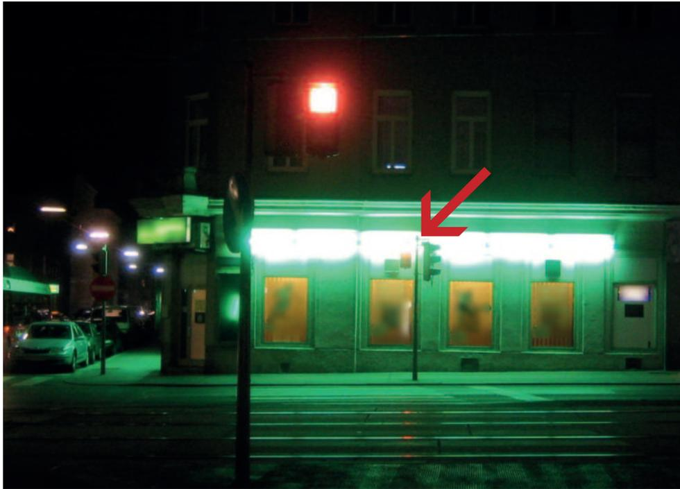
Abb. 45: Beispiel für die Beeinträchtigung der Verkehrssicherheit: Überstrahlung einer Fußgängerampel
